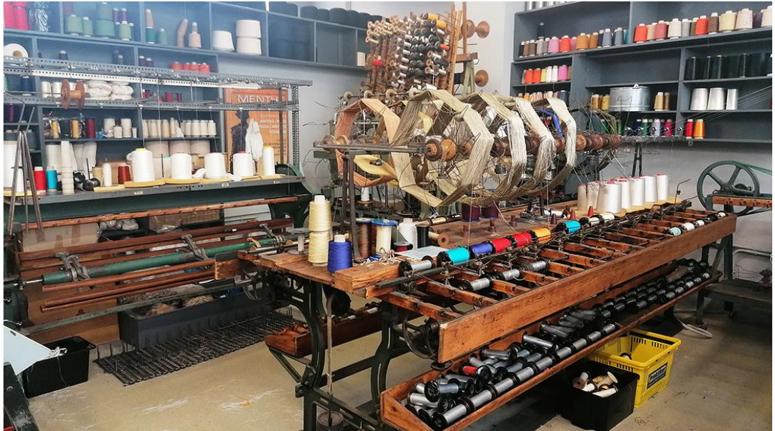
Εικόνα 12: Καρουλίστρα γαλλικής κατασκευής με ιταλικό κινητήρα (1915)
