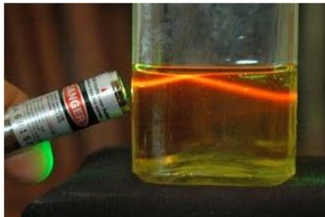
Εικόνα 5: Απομόνωση χλωροφύλλης από φύλλα σπανακιού και φθορισμός της χλωροφύλλης, με επίδραση πράσινης ακτινοβολίας LASER
