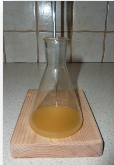
Στην κωνική φιάλη: ελαιόλαδο και αλκοόλη με 2-3 σταγόνες διαλύματος φαινολοφθαλεΐνης Στην προχοΐδα: πρότυπο διάλυμα NaOH
