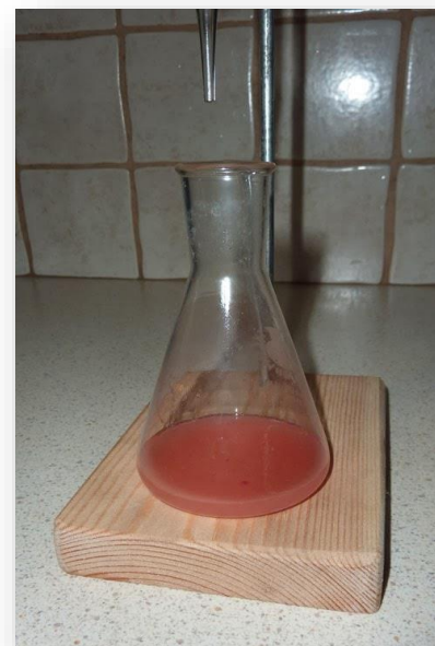
Στο τελικό σημείο της τιτλοδότησης, το διάλυμα στην κωνική χρωματίζεται φούξια.
