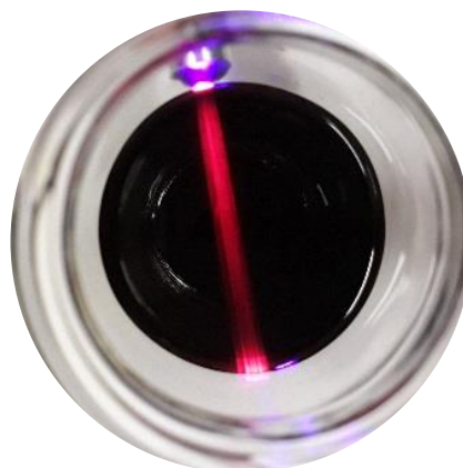
Εικόνα 2: Απομόνωση χλωροφύλλης από φύλλα σπανακιού και φθορισμός της χλωροφύλλης.
